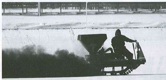
▲融雪剤散布の様子
